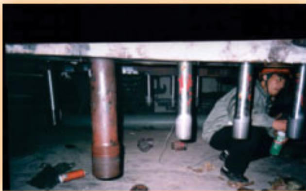
N-5000 用于热电厂汽机缸头螺栓，方便检修时拆卸
