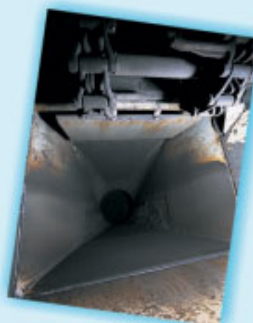
刷涂陶瓷防护剂可有效保护金属免受磨损, 延长零部件使用寿命
