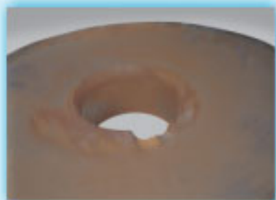
磨损的渣浆泵护板
