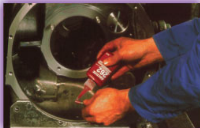
双头螺栓用 乐泰 ® 螺纹锁固胶锁固。
