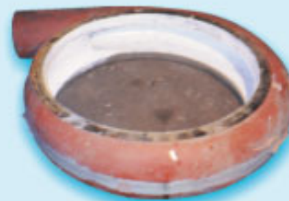
修复后的渣浆泵护套
