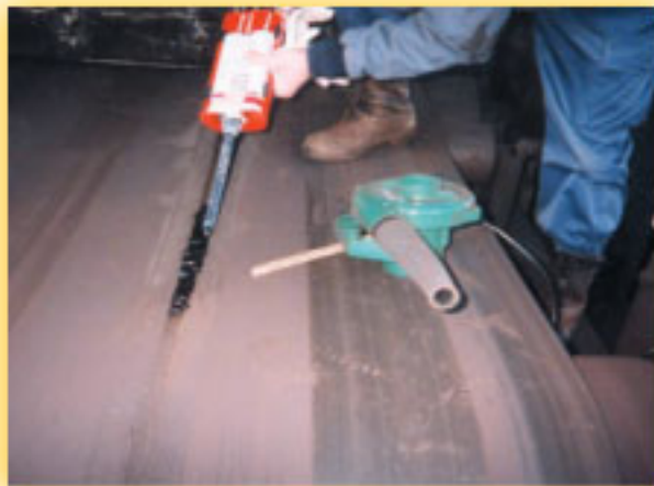
修补运输皮带上的划伤等缺陷， 避免造成皮带局部报废
