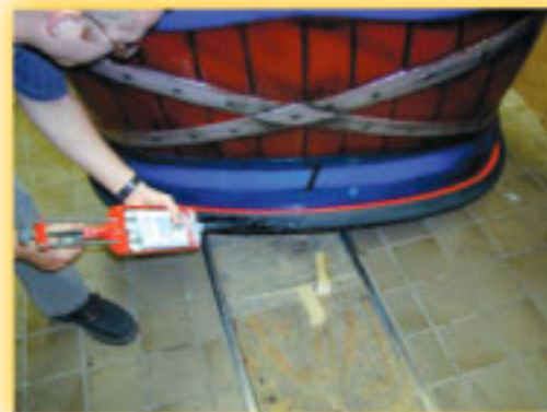
碰碰车外胎破损的修复
