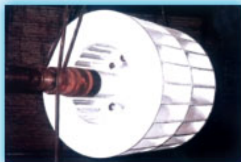
整个表面应用 乐泰® Nordbak® 刷涂陶瓷防护剂 96443 涂刷。
