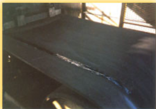
修补运输皮带上的划伤等缺陷， 避免造成皮带局部报废
